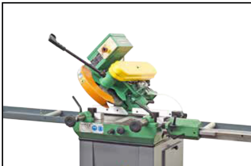
Lade- und Entladerollbahn mit Anschlag
