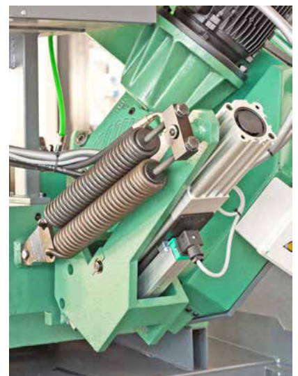
Hydraulischer Zylinder mit doppelter Sicherheitsfeder und Linearpotentiometer
