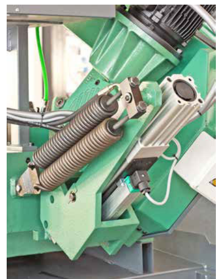
Hydraulischer Zylinder mit doppelter Sicherheitsfeder und Linearpotentiometer
