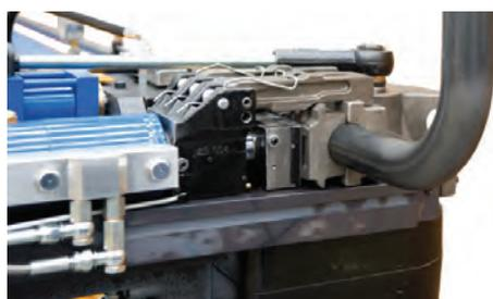
Dettaglio del sistema di serraggio tubo
