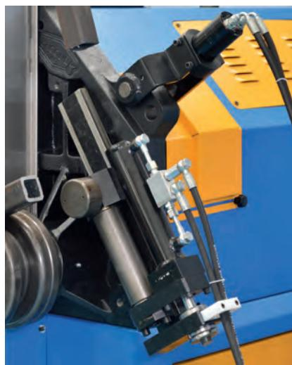
Raddrizzatore (correttore di spalla) laterale idraulico
