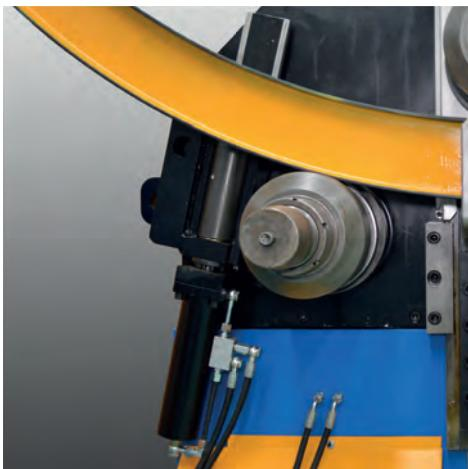
Raddrizzatore laterale idraulico
